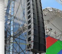
Primeira caixa fabricada no Brasil com , entrada digital AES /EBU e controle via TCP-IP - FZJ15A
